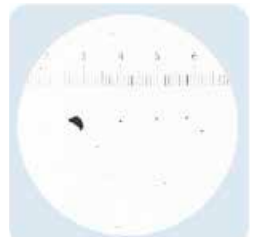
NAS 6 ISO 17/15/12 現行大部分液壓系統 需要的
