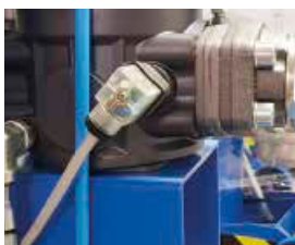
Versioni con indicatore d'intasamento elettrico/visivo
