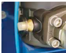
Versions avec indicateur de colmatage différentiel visuel
