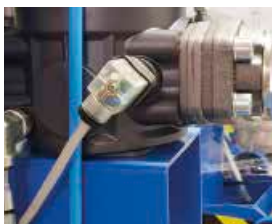
Ausführung mit optischer/elektrischer Anzeige
