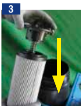
3 Insérer la coupelle bypass ou la coupelle borgne dans l'élément filtrant
