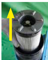
3 Retirer l'élément filtrant
