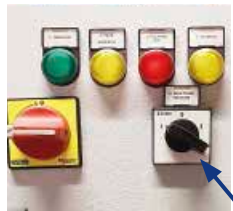
Phasen-Wechselschalter nur in der Ausführung mit Partikelzähler ICM2.0
