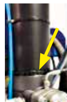
5 S'assurer que la cuve est bien serrée
